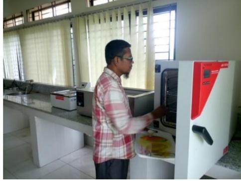
চিত্রঃ Hot Air Oven
