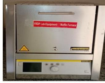
চিত্রঃ Muffle Furnace
